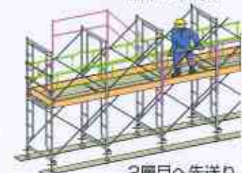
外側・躯体側・妻側 幅木の取付け
