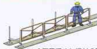
1層目手すり機材の取付け
