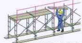
1層目作業床の取付け
