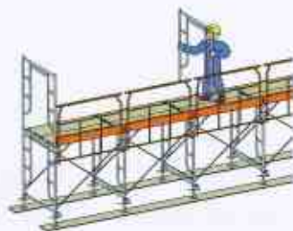
2層目建わくの取付け
