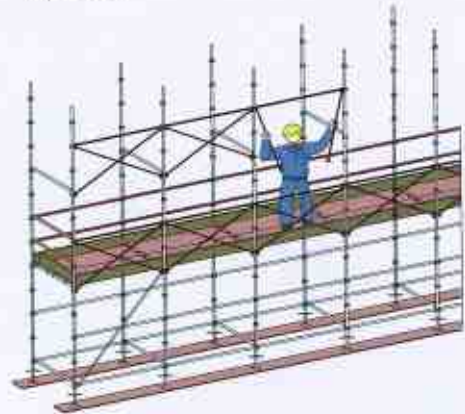
くさび緊結式足場の手すり据置き方式
