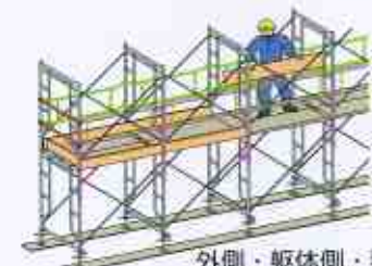
外側・躯体側・妻側 幅木の取付け
