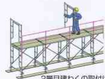
2層目建わくの取付け
