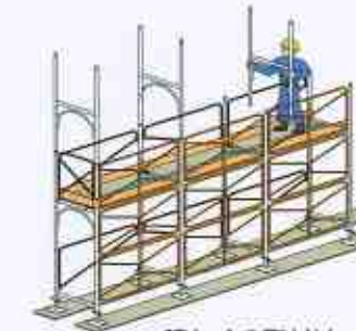
建わくの取付け
