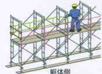
躯体側 二段手すりの取付け
