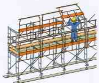
2層目据置き手すり機材の取付け
