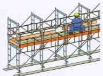
躯体側・妻側 二段手すり+幅木の取付け
