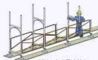
建わくの取付け
