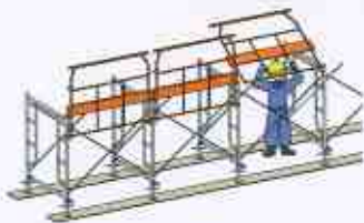
1層目据置き手すり機材の取付け
