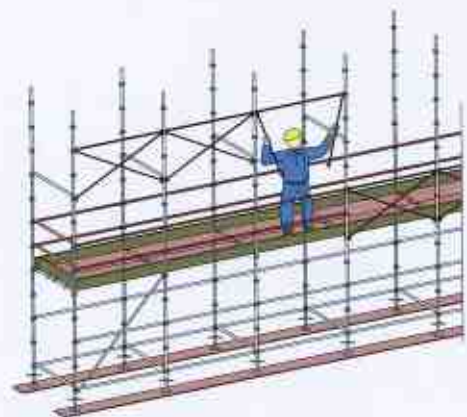
くさび緊結式足場の手すり先送り方式
