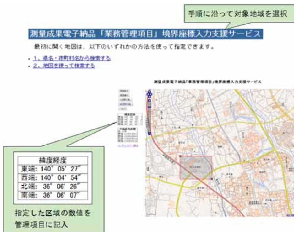
図 5-4 測量成果電子納品「業務管理項目」境界座標入力支援サービス
