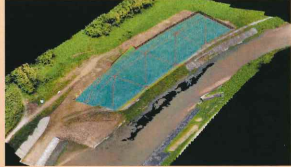
起工測量点群と3次元設計データの重ね合わせ
