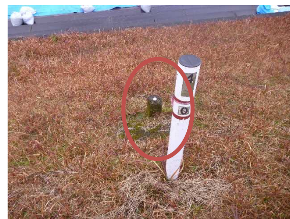
基準点設置状況
