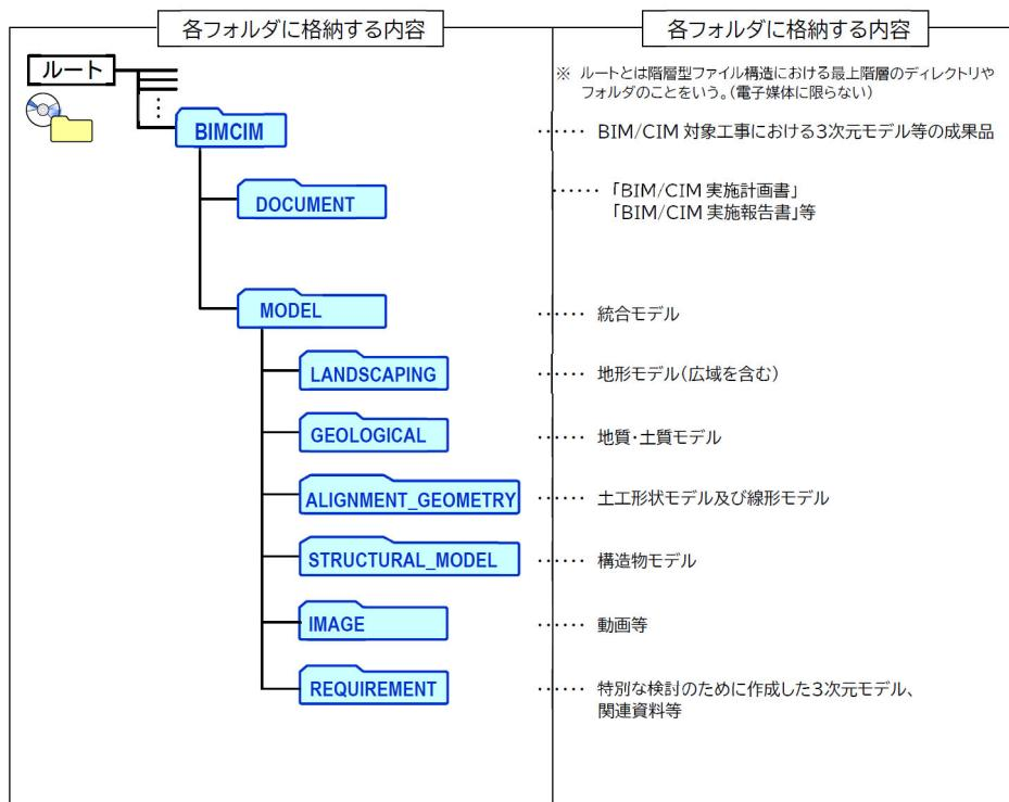
図 3-1 3 次元モデル等の成果品フォルダ構成（BIM/CIM 対象工事）
